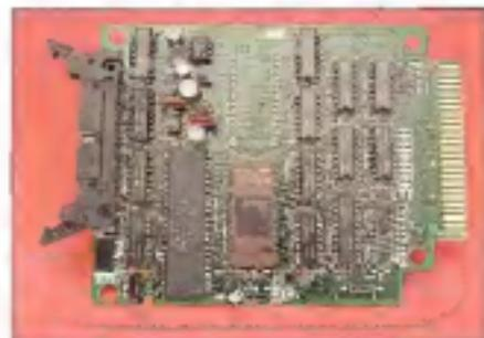
La struttura dell'interfaccia si inserisce nel controller e l'EPROM con il software di gestione.
